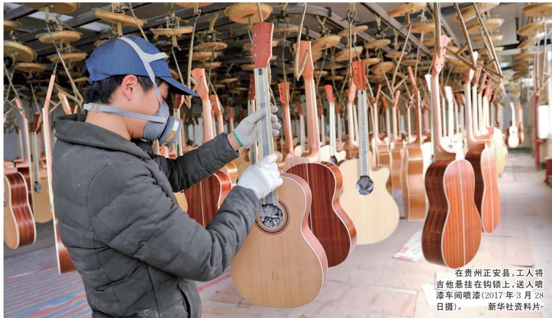
在贵州正安县，工人将吉他悬挂在锁钩上，送入喷漆车间喷漆(2017年3月28日摄)。新华社资料片
